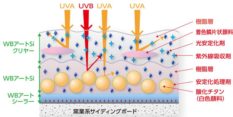
☆高度に耐紫外線設計されたWBアートSiクリアーとWBアートSiを組み合わせて使用することにより、従来のクリアー塗膜の問題点である耐紫外線性を大幅に向上させ、更に層間の密着性に優れた塗膜を形成します。
